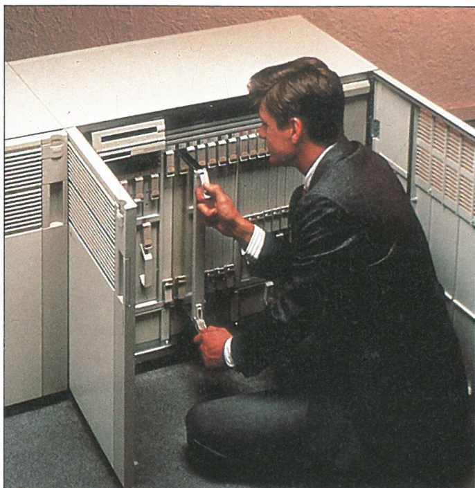
Integrity S2:n voi huoltaa etupuoletta koneen käydessä. Työkaluiksi riittävät kädet.
